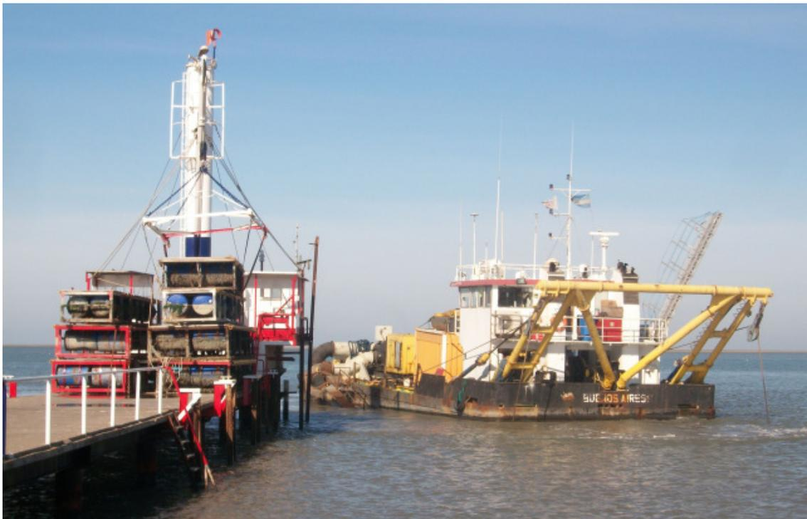
***Nótense las planchadas sobre el muelle a fin de facilitar la maniobra de la draga***
